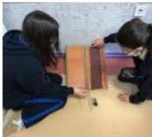
Melis ve Güneş, aynı arabanın cilalı ve zımparalı yüzeyde ilerledikten sonraki durma mesafelerini ölçüyor.
